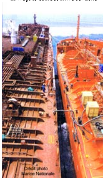
Transbordement du Xylène pour alléger le chimiquier et faciliter le désenhouement
